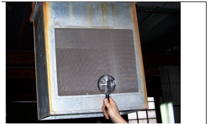
Визначення швидкості повітря припливної вентиляції
