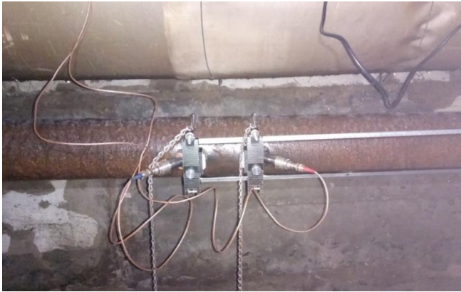
Вимірювання витрат води на окремих ділянках водопроводів за допомогою ультразвукового витратоміра
