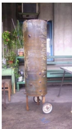
Установка для вимірів витрат пари та утворення конденсату на ділянках паропроводів
