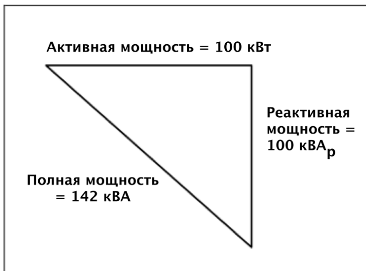
Рисунок 3.22: Активная, реактивная и полная мощность
