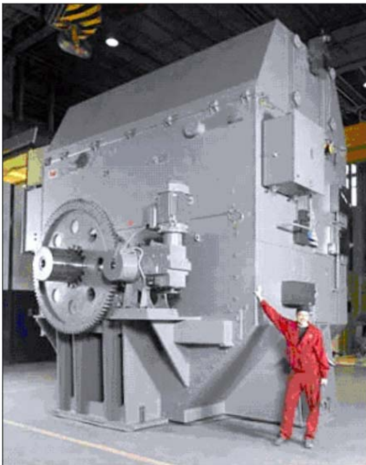
Рисунок 3.26: Привод компрессора с номинальной мощностью 24 МВт
